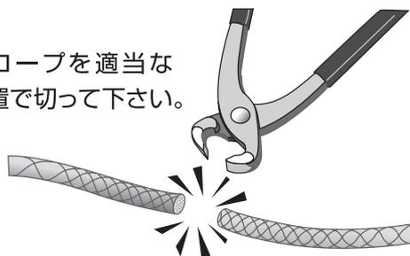
**3** 旧ロープをカッターなどでロープの外周網を切り取りロープの芯を取り出します。
