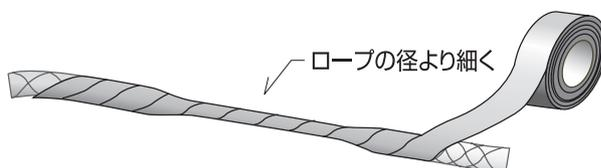
7 昇降ロープに、新しい引き降ろしロープを取付ます。
