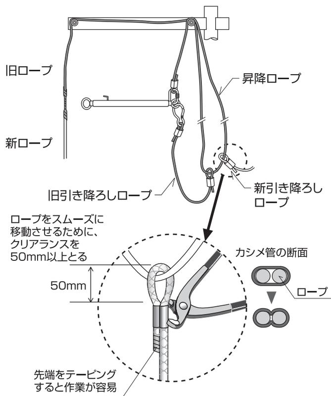
8 旧引き降ろしロープを撤去し、新しい引き降ろしロープをセットして下さい。
