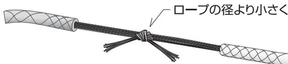
**6** 結び目の上からビニールテープで確実にテーピングします。その際、テープは1重から2重程度に押さえながら巻いて下さい。この径が太すぎますと滑車内を通らなくなります。
